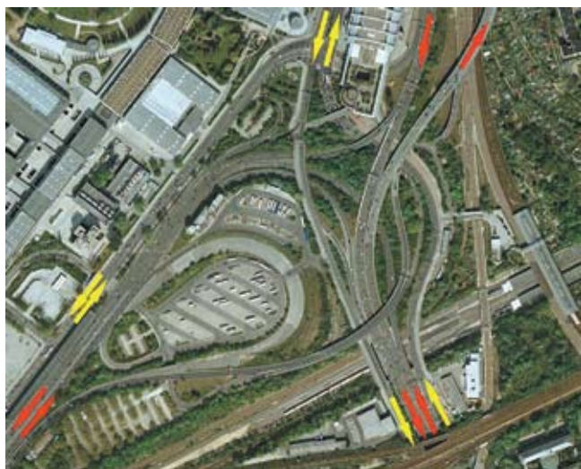
Рис. 5. Узвязка трех высокоскоростных (красные стрелки) и трех уличных (желтые стрелки) направлений в Берлине (снимок из Google Earth)
