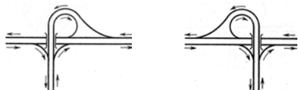
Рис. 6. Варианты примыкания по типу «труба» [4]
