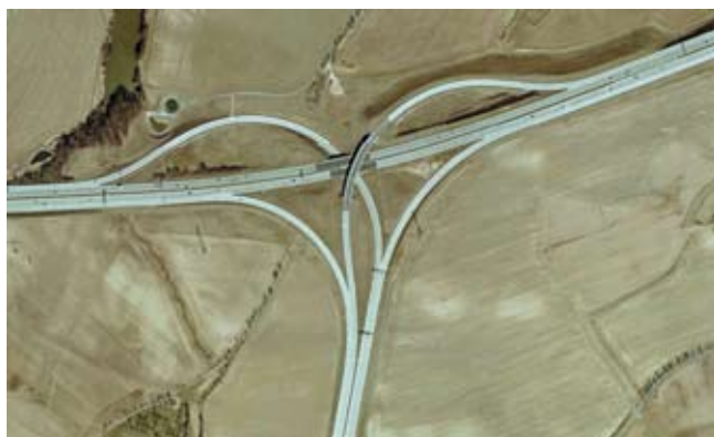
Рис. 8. Тип примыкания «треугольник» на примыкании автобана А17 к А4 (снимок из Google Earth)
